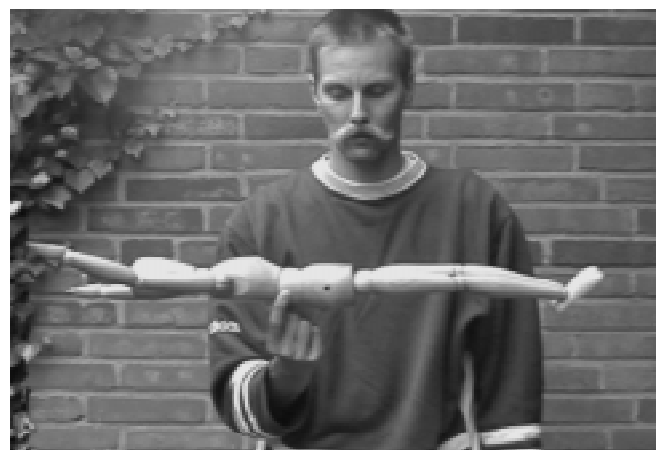
Abbildung 1: Bestimmen des Schwerpunktes bei einem Puppenmodell
